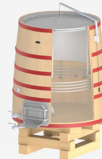
Flexibilidad de la tapa flotante, tecnicidad de la tina troncocónica y autenticidad de la madera. Para responder a la problemática de la variabilidad de la cosecha y a la necesidad de flexibilidad de los contenedores en las bodegas, proponemos una solución que ofrece la adaptabilidad del volumen del sombrero flotante manteniendo las ventajas de la tina troncocónica.
